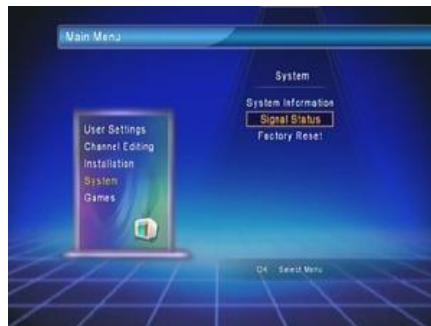
⑩ TV를 켜서 신호를 확인합니다 리모콘의 MENU>System>Signal Status >OK를 누르면 신호상태를 확인할 수 있습니다 (채널,볼륨버튼 이용)
