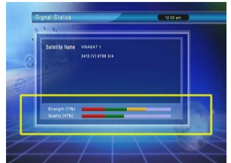
⑪ 여러 채널의 신호상태를 확인하세요 품질이 40% 이하이면 안테나를 다시 미세 조정하여 품질이 47% 이상이 되도록 조정 후 단단히 고정 하시기 바랍니다 주의: 안테나 양카,실리콘 고정시 신호값이 변하지 않게 신호값을 보면서 조심스럽게 고정 하시기 바랍니다
