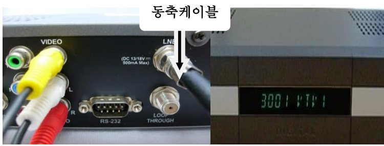
① 수신기 뒷면의 LNB IN 단자와 LNB를 제공된 동축케이블로 채널을 3001번(VTV1)에 맞춥니다
