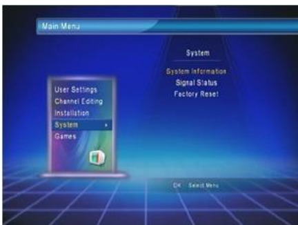
⑩ TV를 켜서 신호를 확인합니다 리모콘의 MENU>System>Signal Status >OK를 누르면 신호상태를 확인할 수 있습니다 (채널,볼륨버튼 이용)
